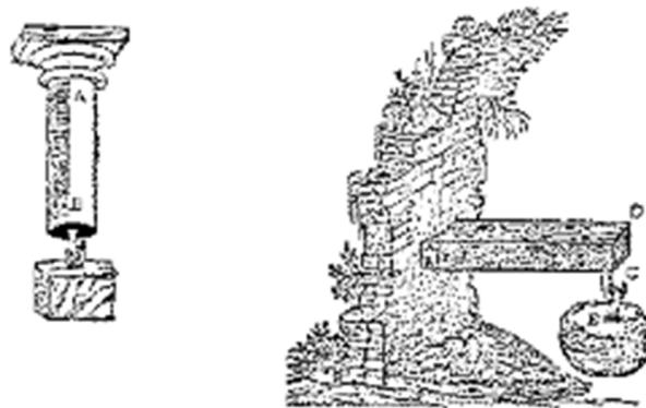
**Figure 1** : Dessin de Galilée illustrant les essais de traction et de flexion
