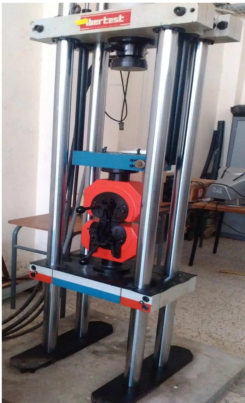
**Figure 16** : Machine de traction
