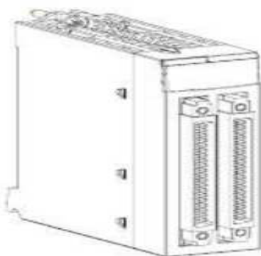
Figure (IV.3) : Module E/S avec 40 broches
