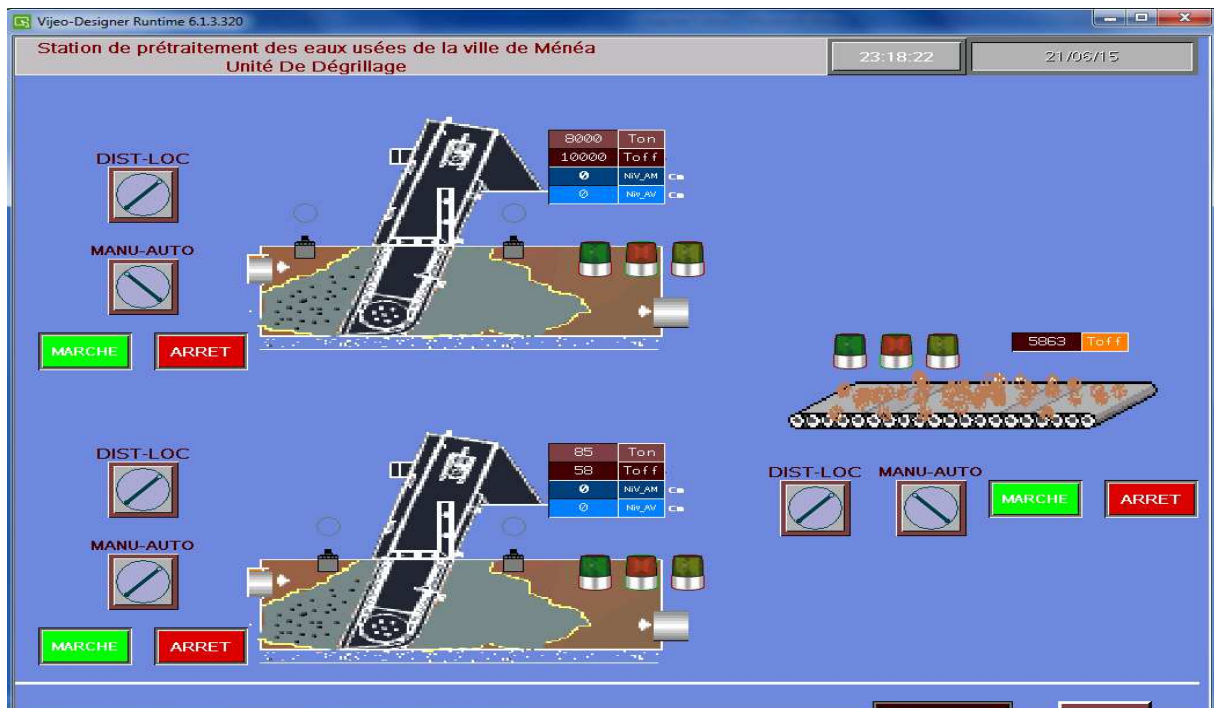
Figure (V.7) : Vue unité dégrillage
