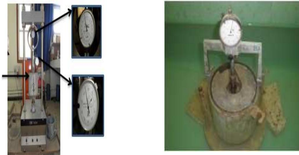
Figure V-7 :L'exécution du poinçonnement et de l'immersion.
