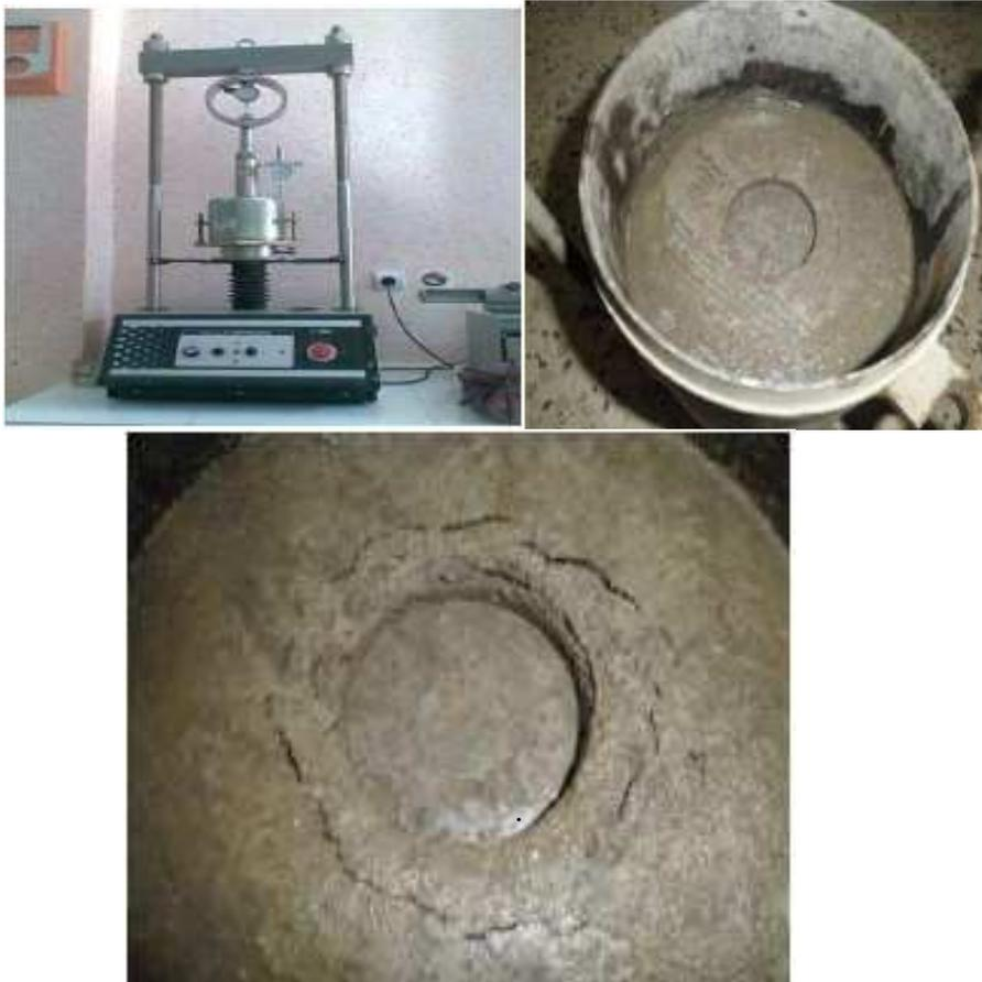
Figure V-4: L'exécution et le résultat du poinçonnement
