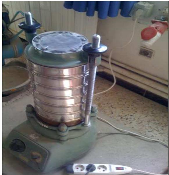
Figure III-1 : Matériels d'analyse Granulométrique
