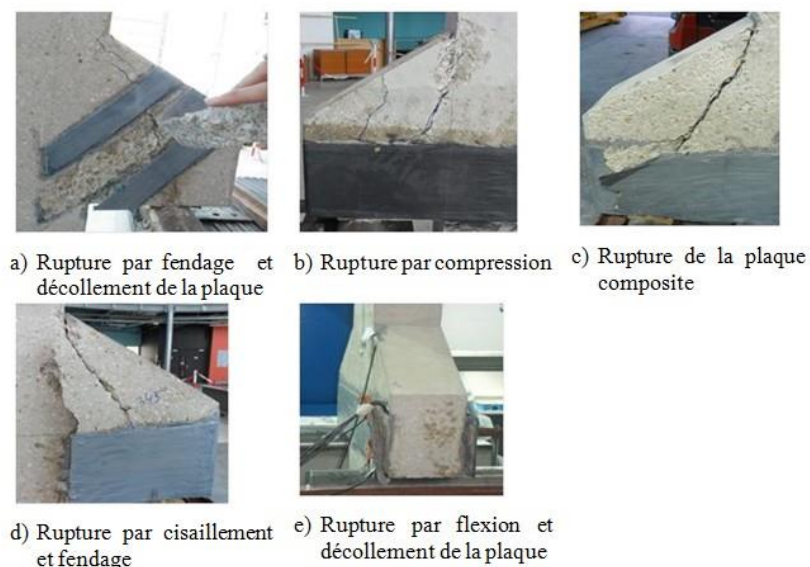
Figure I.13: Renforcement ou réparation de structures en béton armé par collage de matériaux composites [24].
