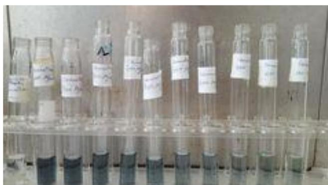
**Annexe 6 :** Photographie des dilutions réalisées pour le test du pouvoir réducteur du fer d'un des extraits aqueux
