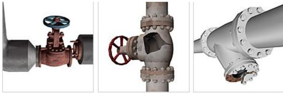
Exemple de conduites endommagées par des coups de bélier
