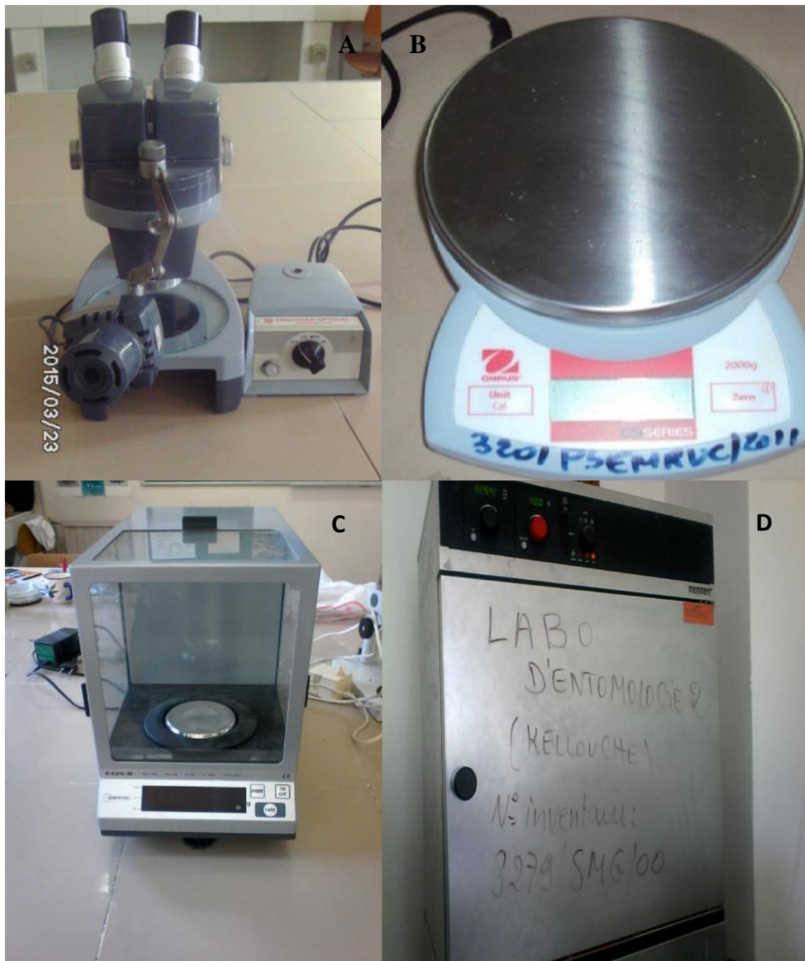
Figure 8: Matériels de laboratoire utilisés, (A) : loupe binoculaire, (B) : Balance, (C) : Balance (précision 0.01g), (D) : Etuve réfrigérée. Originale 2015.
