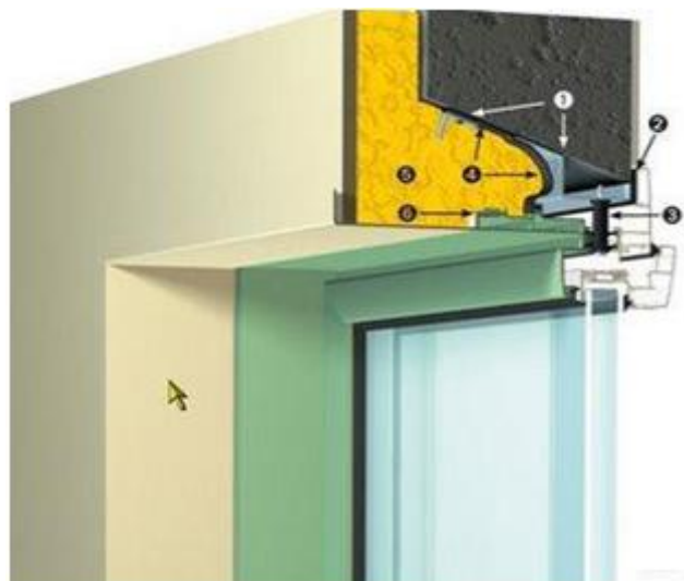
Figure II.18: Isolation thermique par l'extérieur : les solutions menuiseries. [13]
