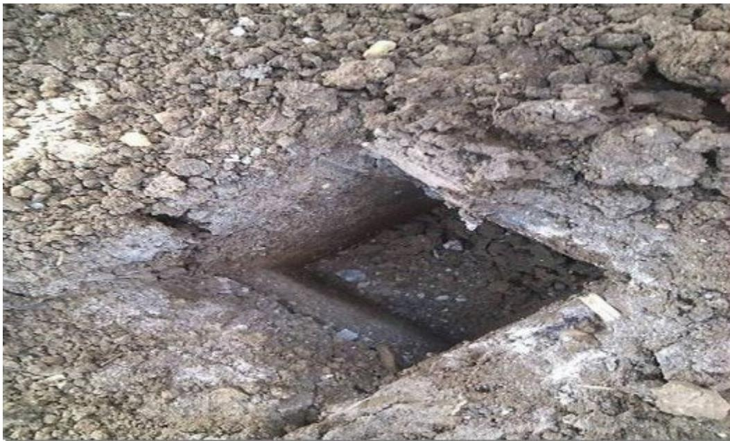
**C** : Retirer le quadrat, L'échantillon Doit représenter deux niveaux de la surface du sol
