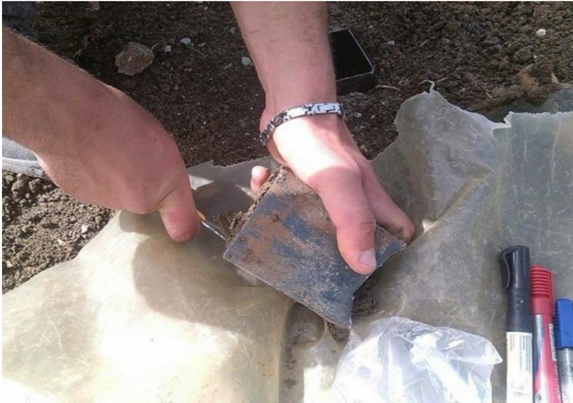
**D** : Avec un instrument adapté et rigide, récupérer le contenu du quadrat sur la bâche en plastique
