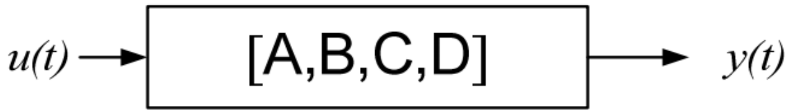
Figure (2-2) : Système en boucle ouverte
