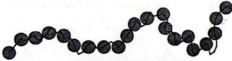
Figure I-13 : Mesure de la dimension d'une courbe par la méthode des boules disjointes
