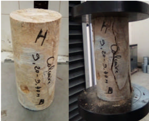
a- Epreuve de Calcaire 9.20-9.40m PK14+900
