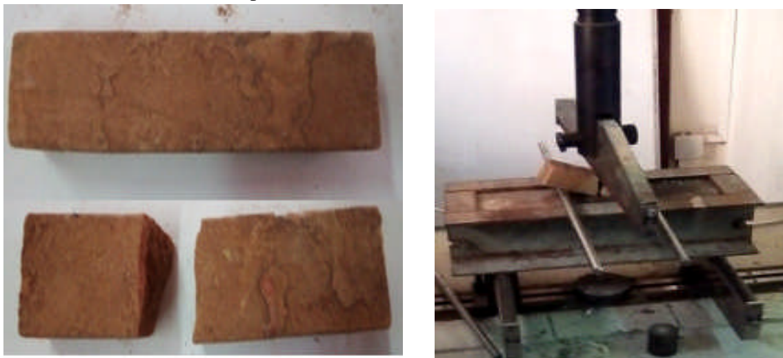
c- Epreuve de Grès friable PK14+900.
