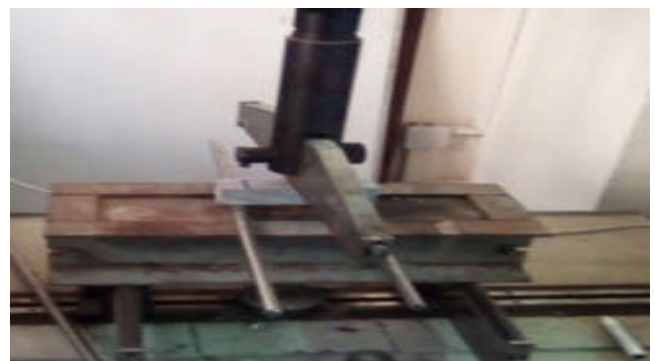
Figure IV.33. Dispositif de l'essai mécanique de rupture par flexion (3 points) [Laboratoire UR-MPE/FSI-Boumerdes]
