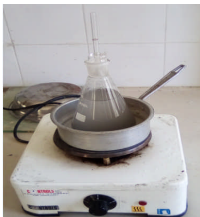
(d) Élimination des bulles d'air Par ébullition à la plaque chauffante
