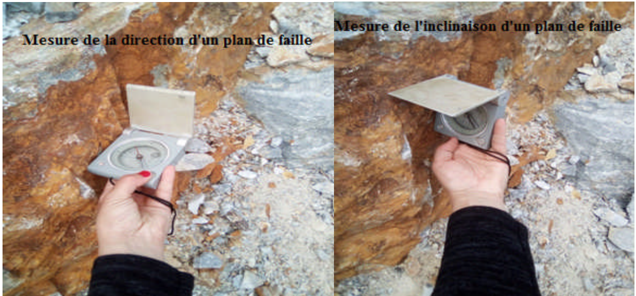
Figure I.11. Mesures de l'orientation du plan de discontinuité (Marbre d'Ait Yahia Moussa).
