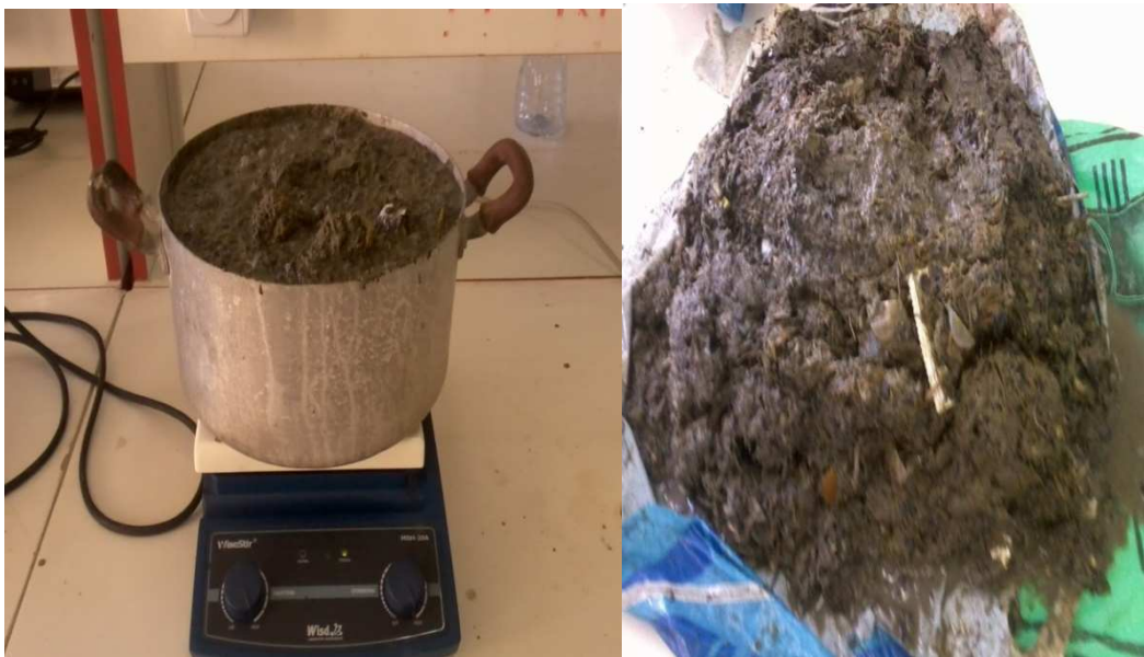
Figure 8 : Image du rejet 1 (déchet obtenu après chauffage et tamisage)
