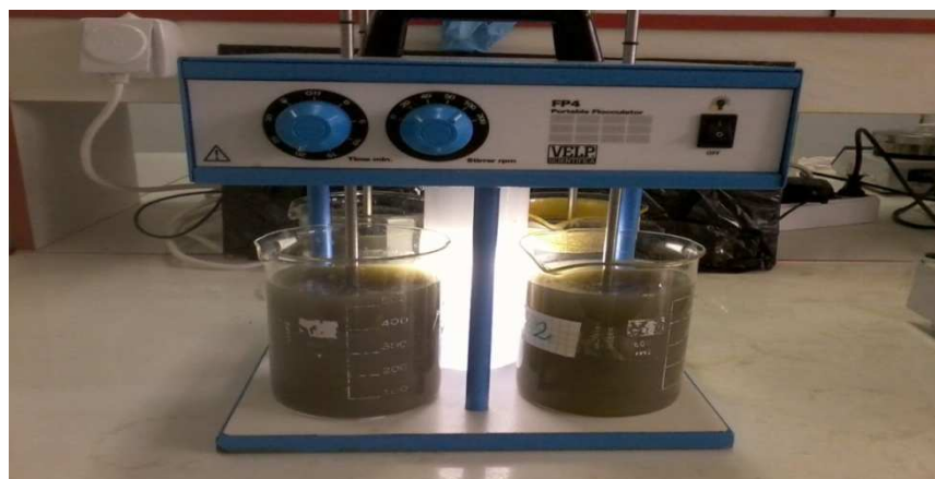
Figure 9 : Jar test du laboratoire
