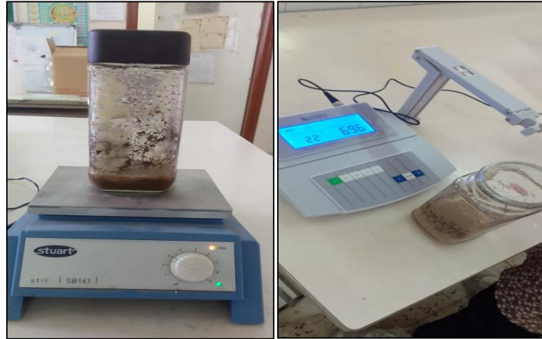
Figure 21: Mesure du pH de l'extrait aqueux de la solution du sol (Boumrar, 2023)
