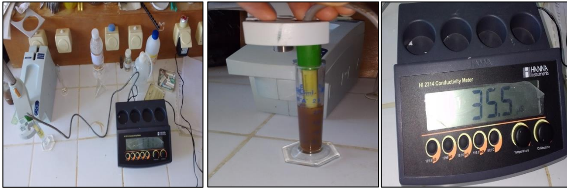
Figure 22 : Méthode de mesure de la conductivité électrique (Boumrar, 2023)
