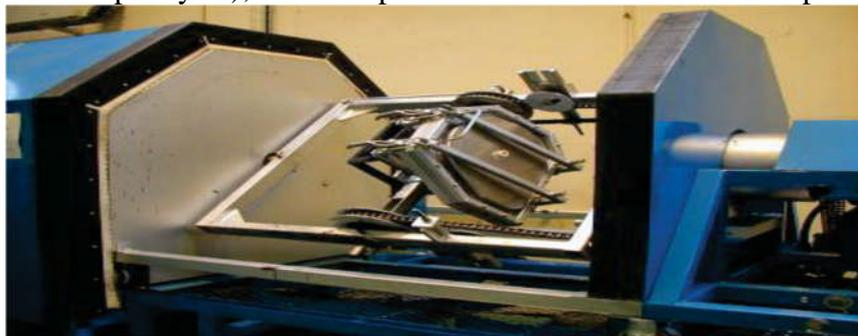
Figure 16 : Exemple de poste de roto-moulage.
