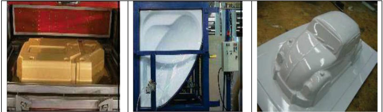
Figure 10 : Objets mis en œuvre par thermoformage.
