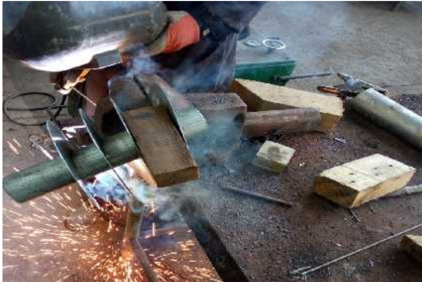
Figure III.7 Montage des hélices sur le tube
