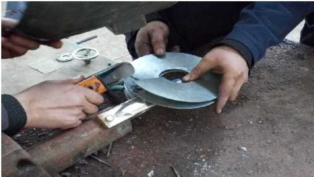
Figure III.6 Assemblage des disques avec soudage
