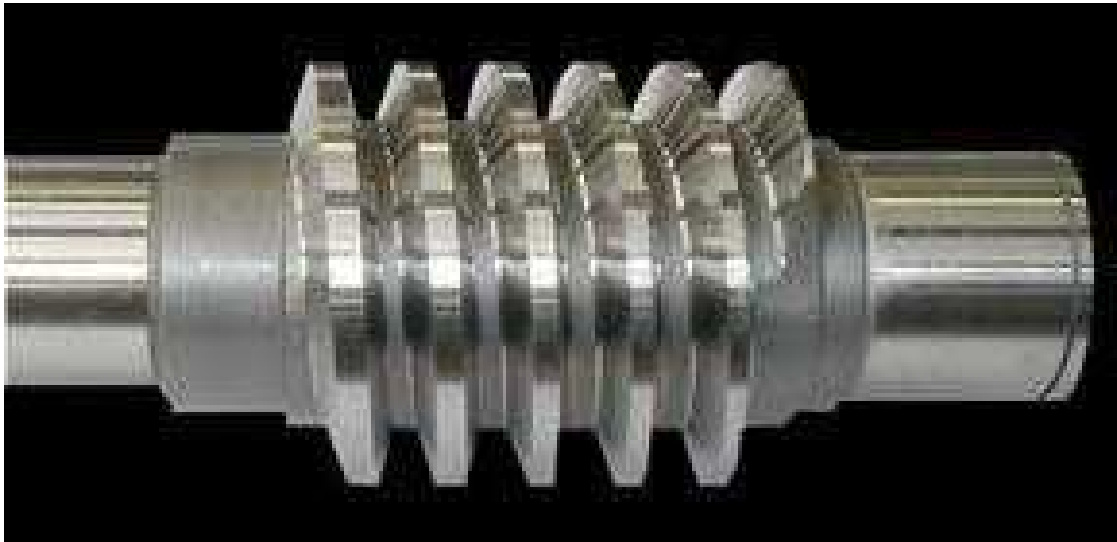
Figure I.1 : Une vis sans fin avec usinage [1]
