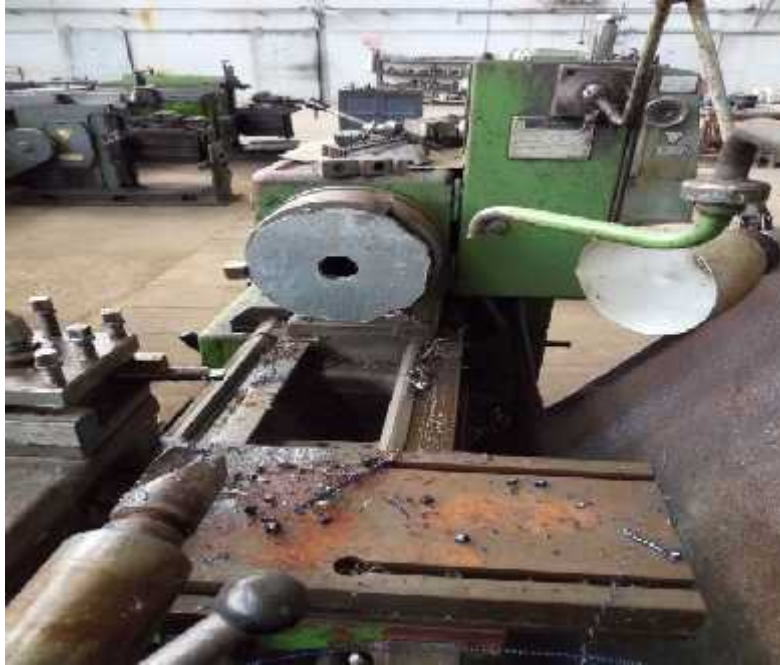
Figure III.3 Le perçage pour avoir le diamètre intérieur
