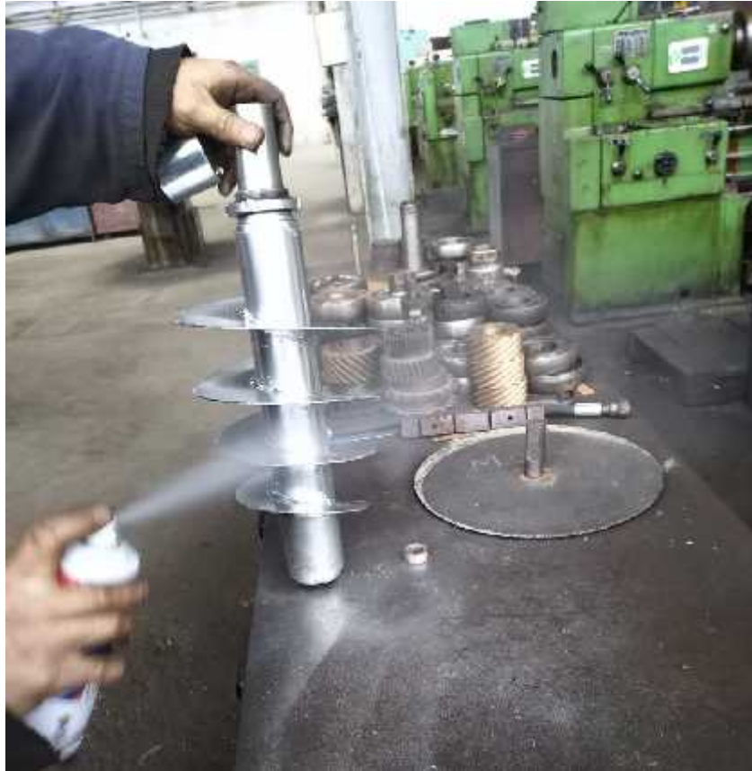
Figure III .9 Finition de la vis sans fin de compacteur de la filature
