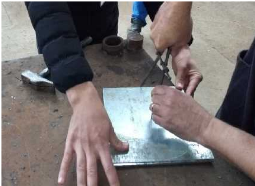
Figure III.2 Traçage des carrés à l'aide d'un pointeau pour avoir un diamètre précis
