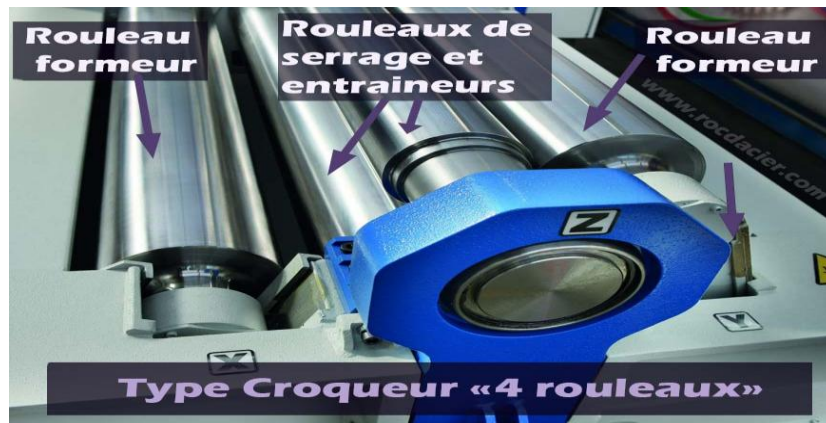
Figure II.30 : rouleuse croqueuse
