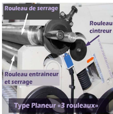
Figure II.29 : roulage de type planeur
