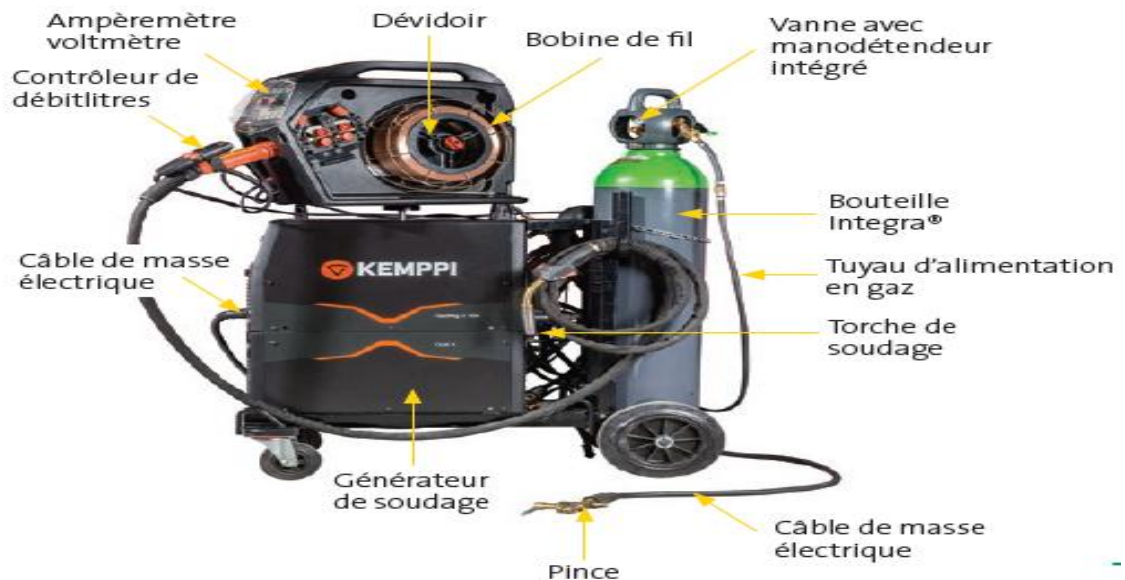
Figure II.52 : poste à souder MIG/MAG
