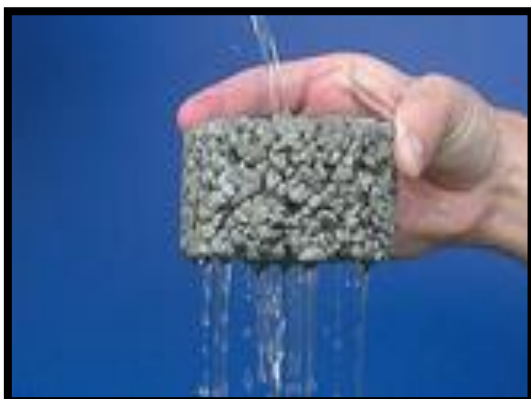
Figure 27 : photo du béton caverneux.
