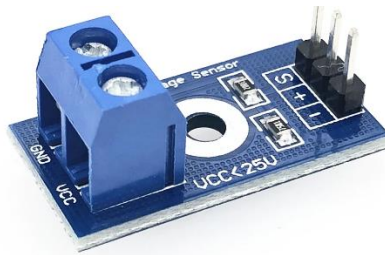
Figure 3.9 – Capteur de tension B25 0-25V
