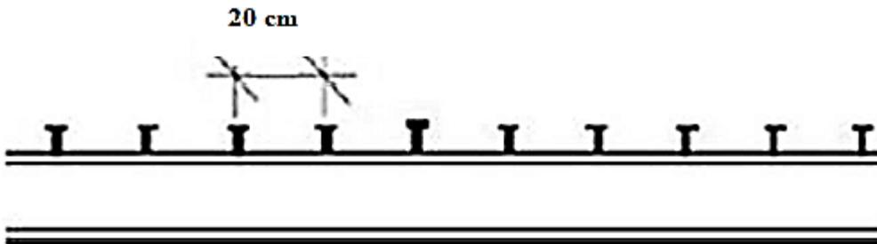
Figure IV.8 Espacement entre connecteurs.
