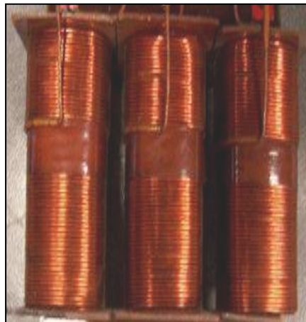
Fig. I.4. Enroulement triphasé d'un transformateur
