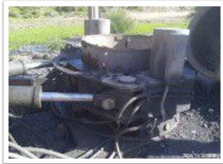
Figure 37: Une table de rotation (original)
