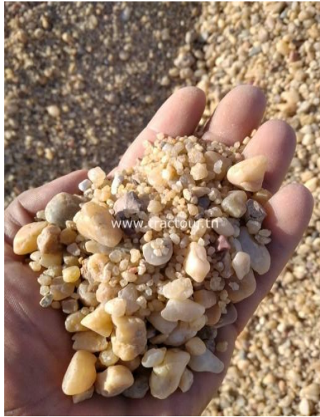
Figure 22 : Gravier de filtration
