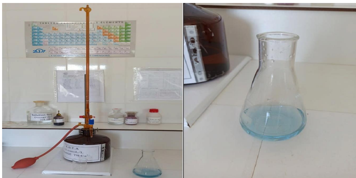
Figure 4 : Dosage volumétrique du calcium (Photographie originale, 2022).
