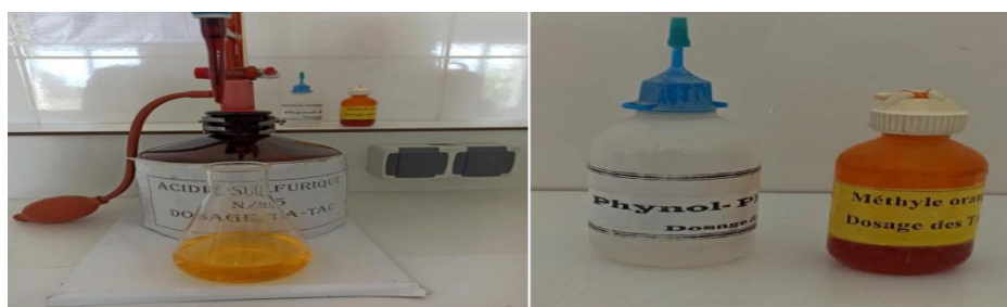
Figure 5 : Dosage de l'alcalinité (Photographie originale, 2022).
