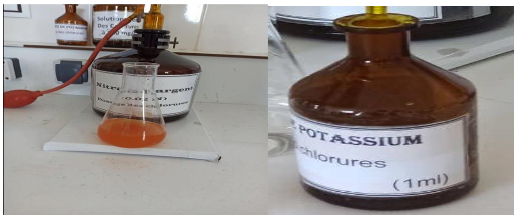
Figure 6 : Dosage des chlorures (Photographie originale, 2022).
