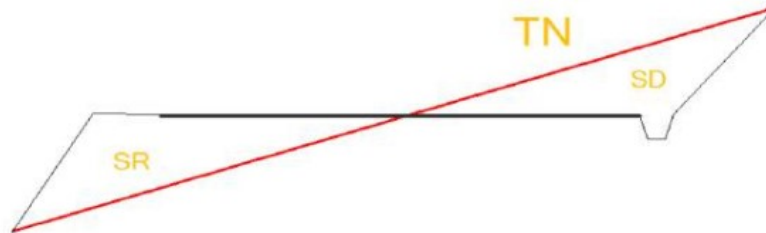
FIGURE VI.1 – profil en travers.
