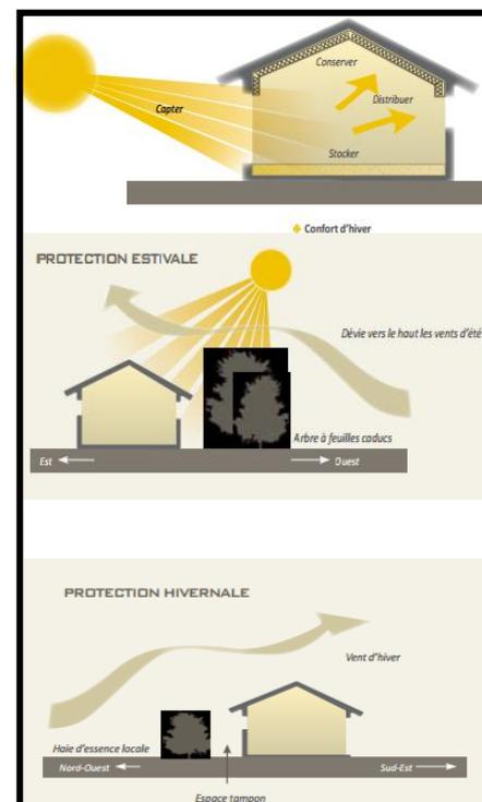
Figure 78 : protections des vents / Source : rapport de la C.A.U.E
