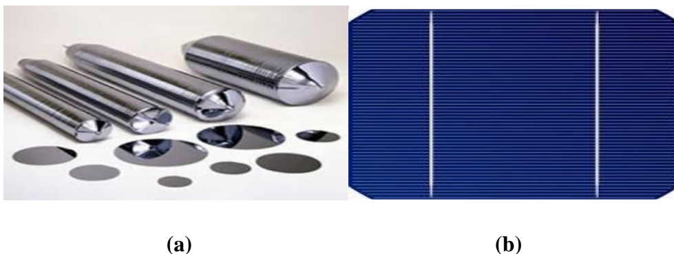
Figure I.2. (a) Les lingots du mono-silicium, (b) Cellule solaire monocristalline.
