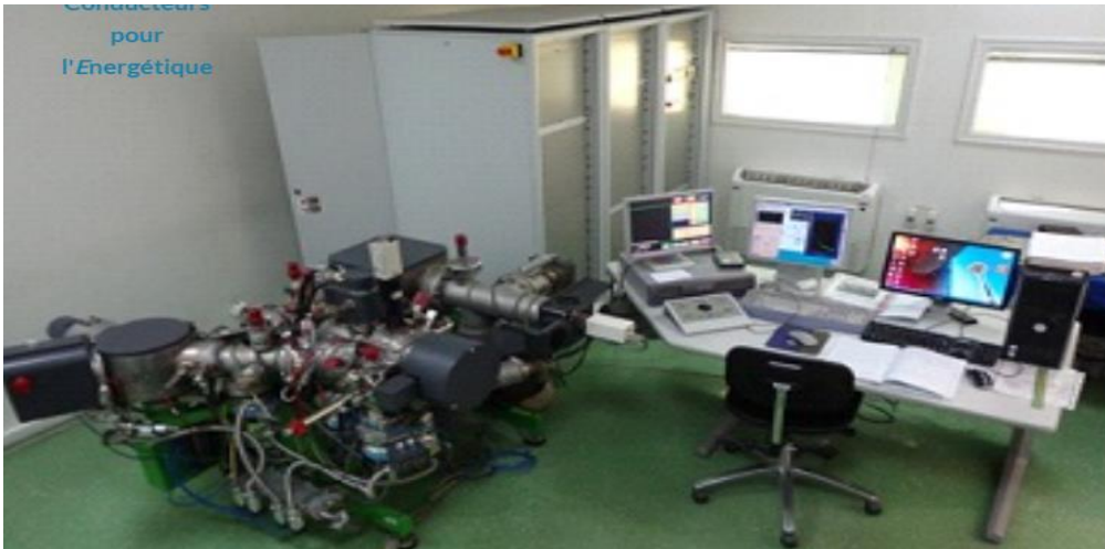
Figure II.8. L'Appareillage de la spectroscopie de masse des ions secondaires (SIMS), « Cameca IMS4FE »(CRTSE).
