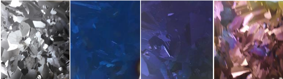
Colorations des plaques de multi-silicium après le recuit à différentes températures.
