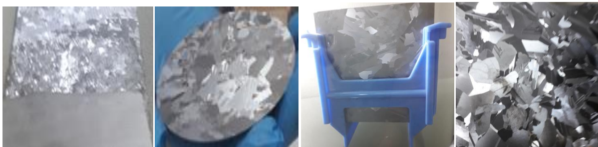
Figure I.4. Des wafers en multi-silicium.
