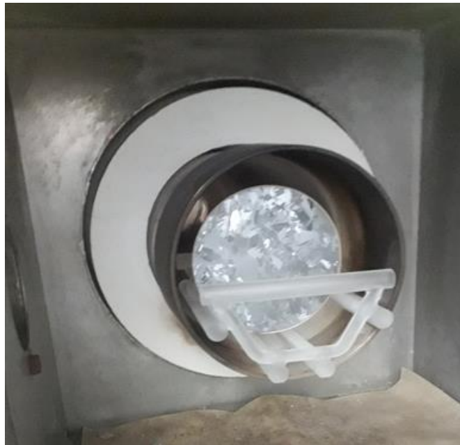
Figure III.12. Les échantillons à l'entrée du four TEMPRESS (CRTSE).
