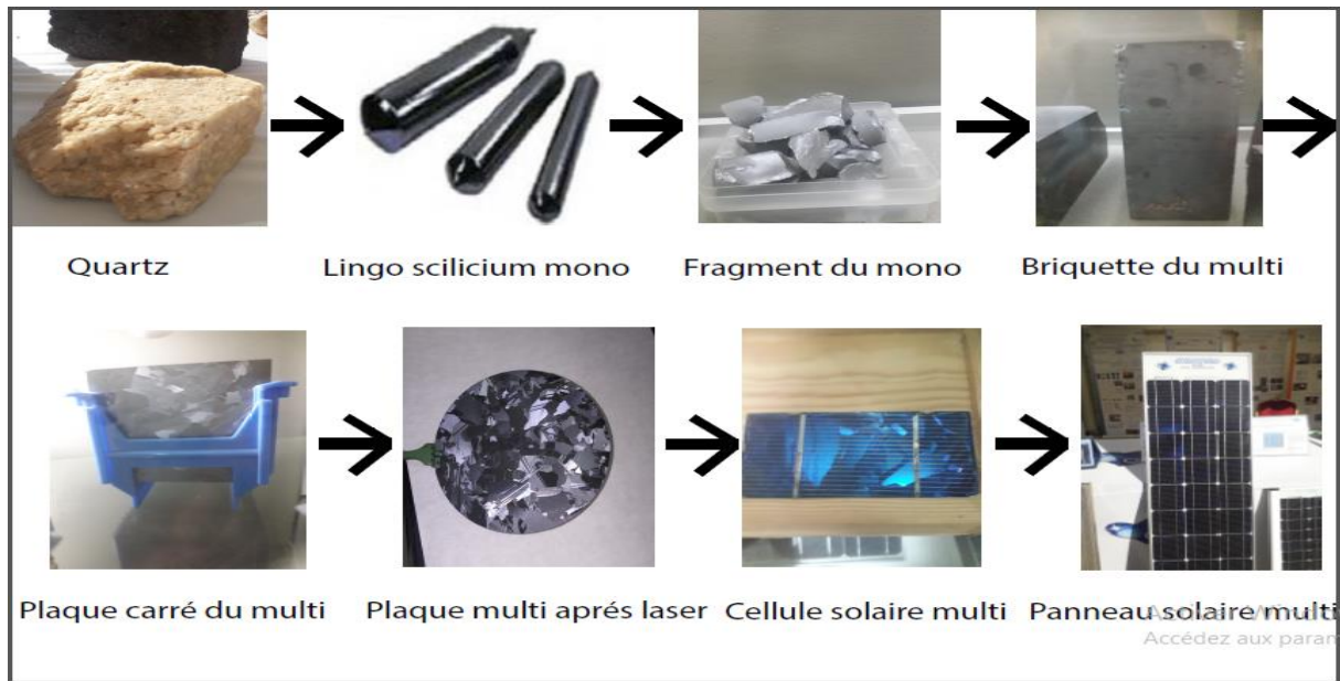
Figure.I.9 : Le silicium, de la matière première au panneau solaire.
