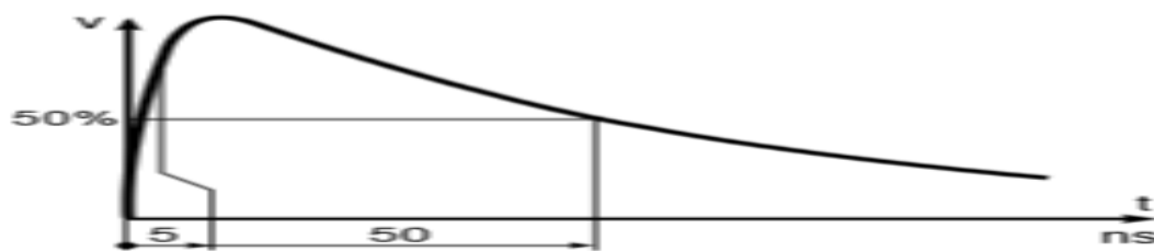
b- onde 5/50ns dite onde impulsionnelle récurrente (simulant par exemple la fusion d'un fusible)
