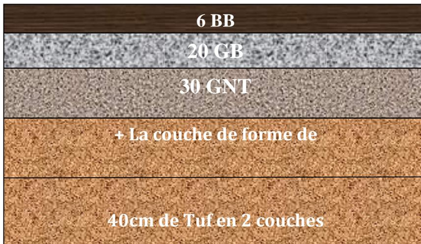
Figure IV-4 structure finale de la chaussée.
