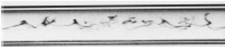
Pour des nombres de Reynolds faibles, la viscosité joue un rôle prépondérant. Les écoulements seront très stables et bien définis (on parle d'écoulements rampants). Ce type d'écoulement est associé aux fluides très visqueux ( $\mu$  élevée), faibles vitesses, pour des systèmes de petites taille ...
