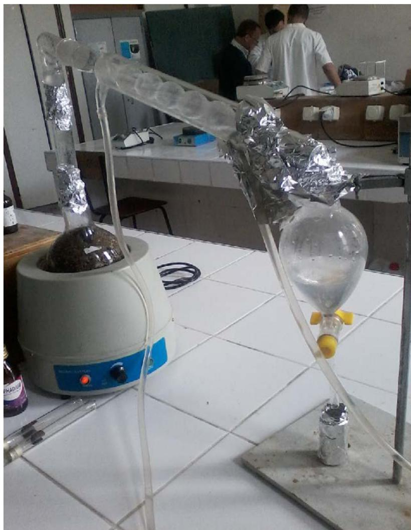
**Fig. 19 : Dispositif de l'hydrodistillation de type Clevenger (Université de Tizi-Ouzou, Institut d'Agronomie, 2014).**
