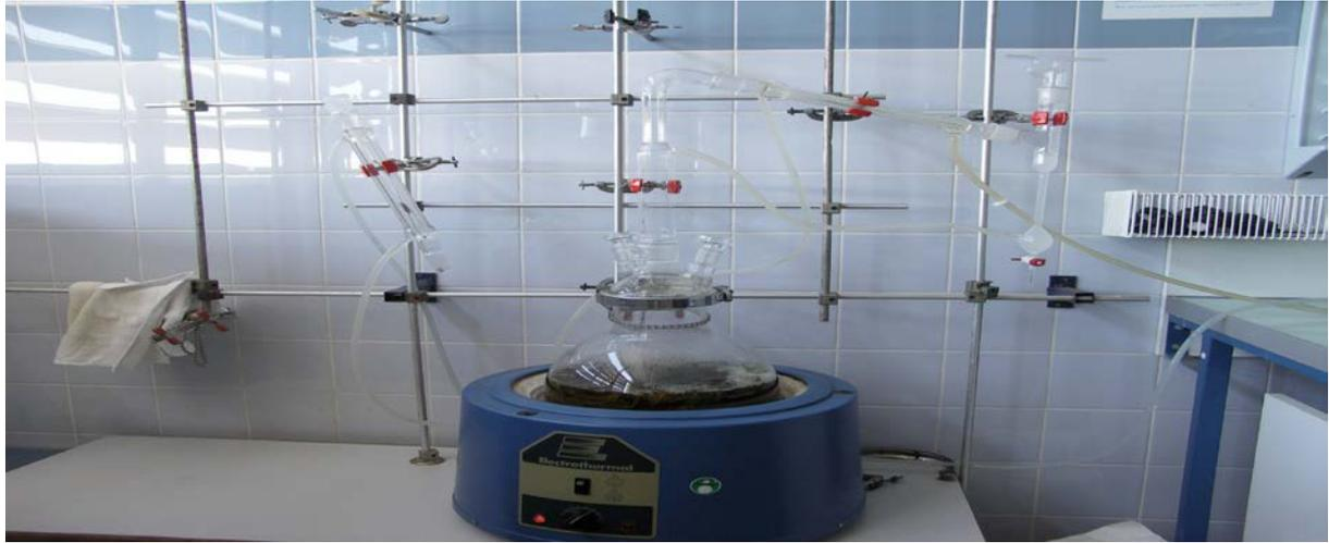
Fig. 3 : « Dispositif de L'hydrodistillation » (Anonyme<sup>4</sup>, 2012).
