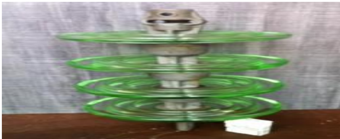
Figure I.9 : Chaîne d'isolateurs à capot et tige
