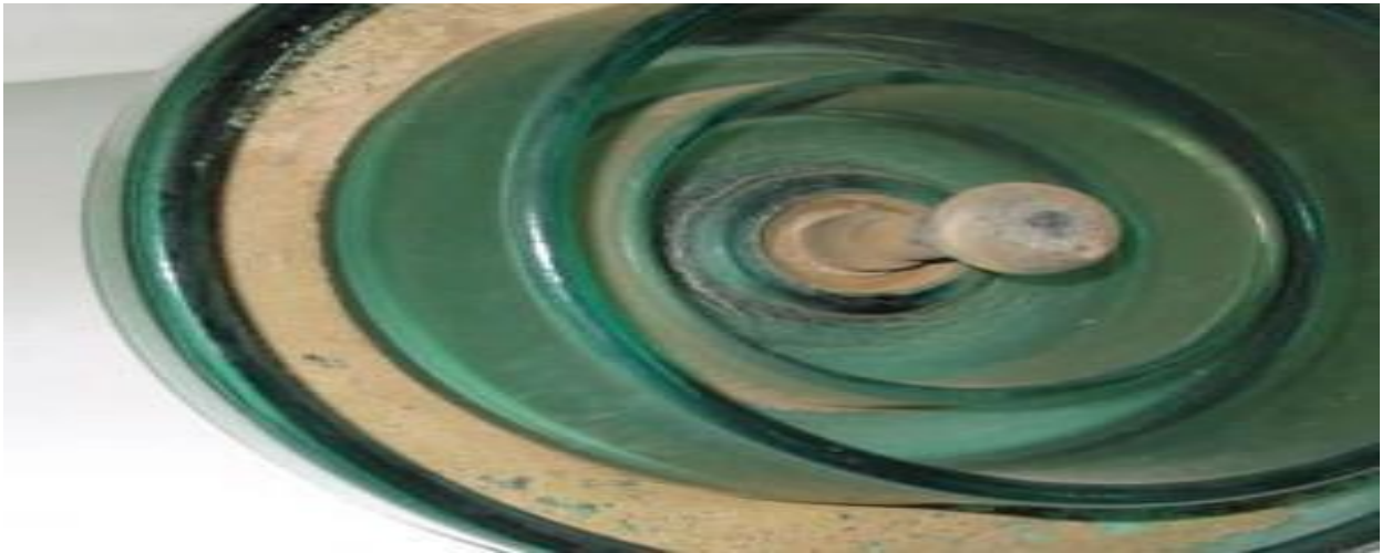
Figure II.3 : Isolateur pollué par le sable
