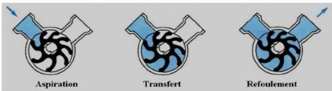
Figure II-12 : Pompes à palettes flexibles (5)
