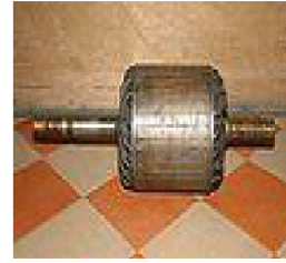
Le rotor, cage constituée de bobinages de cuivre en court- circuit. Les encoches sont légèrement inclinées.
