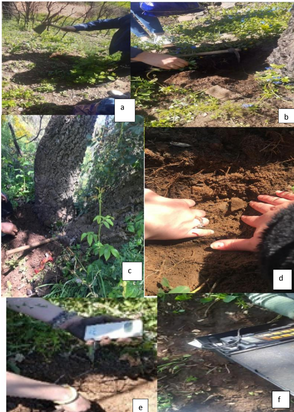
Figure 9 : Les différentes étapes de collecte des échantillons (a,b,c,d) et de mesure de température (e) et l'humidité (f) du sol.
