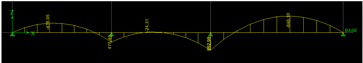
Figure VI. 4: Diagrammes des moments fléchissant à l'ELU sens y-y.
