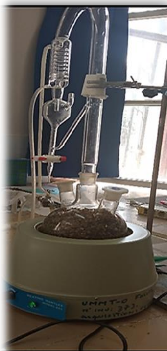
Figure 14. Montage de l'Hydrodistillation par Clevenger (photographie originale).
