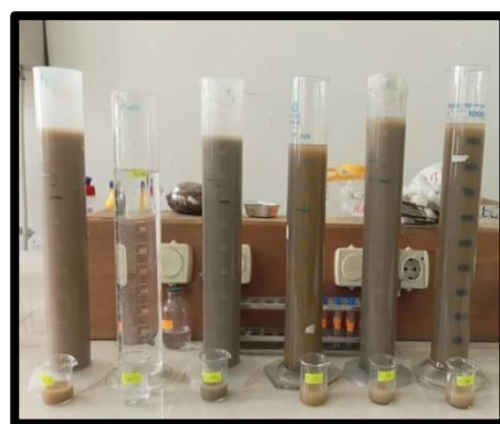
Figure15 : les suspensions dans les éprouvettes.
