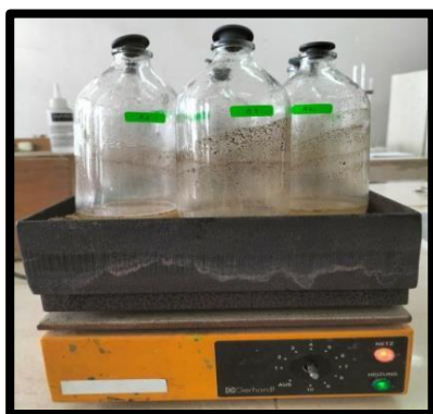
Figure14 : les bécans dans le bain de sable.
