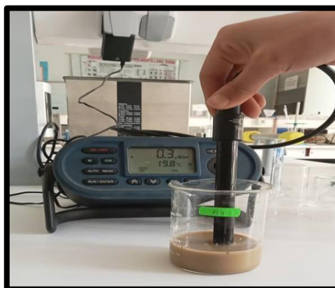
Figure9 : mesure de la CE.
