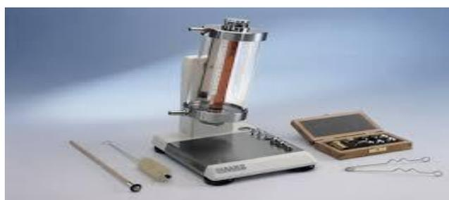
**Figure IV.5** : viscosimètre à chute de bille de marque THERMO électron corporation.
