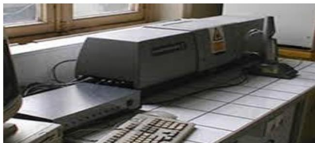
**Figure IV.4** : Granulomètre laser de marque MASTERSIZER, Malvern Instruments.
