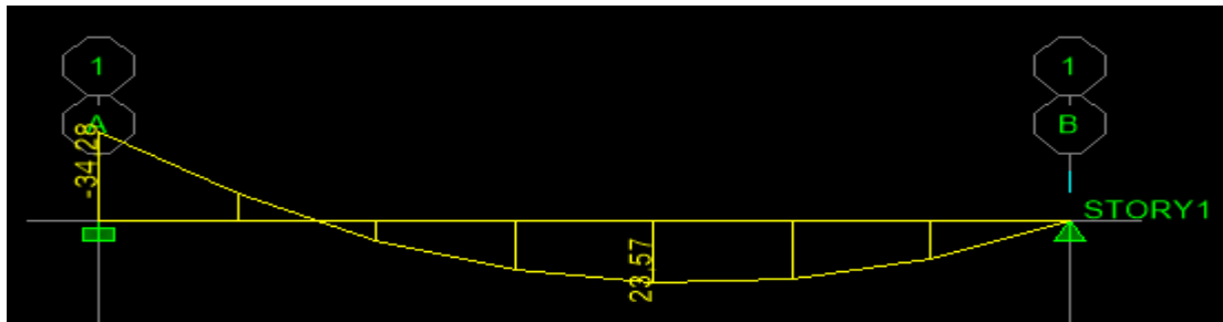
Figure VIII-5 : Schéma statique du mur plaque dans le sens Y-Y à l'ELU.
