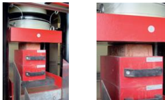
Fig. 2.3. Essai de résistance a la compression sur une brique.
