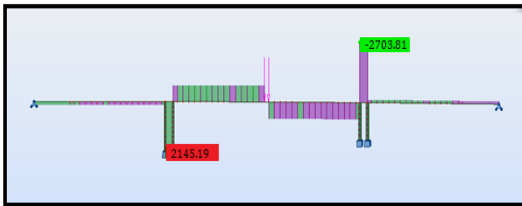
Fig.VI.14: Diagramme des efforts tranchants avant enlèvement de l'équipage de clavage [KN].
