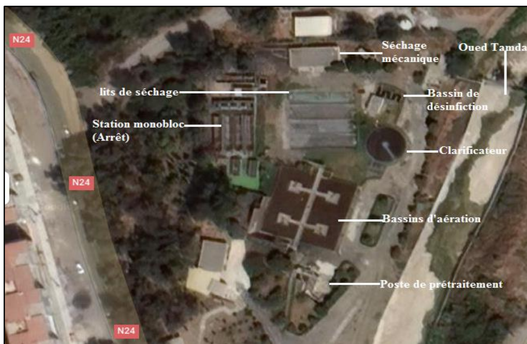
Figure 28 : Photo satellitaire de la STEP de la ville de Tizirt (Google Maps, 2023)
