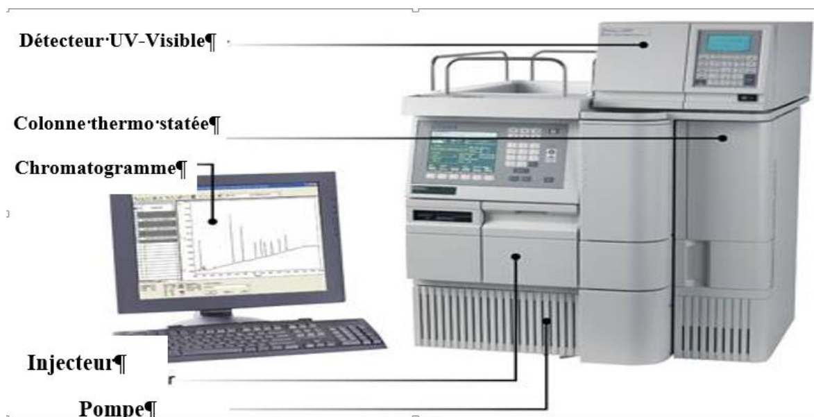
Figure 2: Schéma d'installation de l'HPLC.
