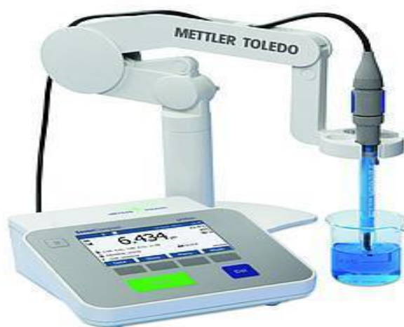
Figure 5: Appareil de conductimétrie et pH-métrie.
