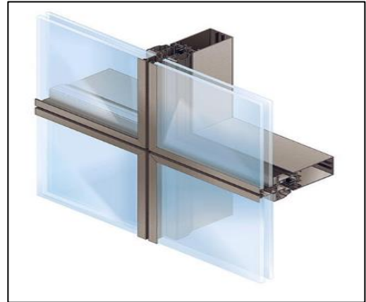
Figure 182 : Murs rideaux en VEC Source : https://www.profiles-systemes.com/menuiserie-aluminium
