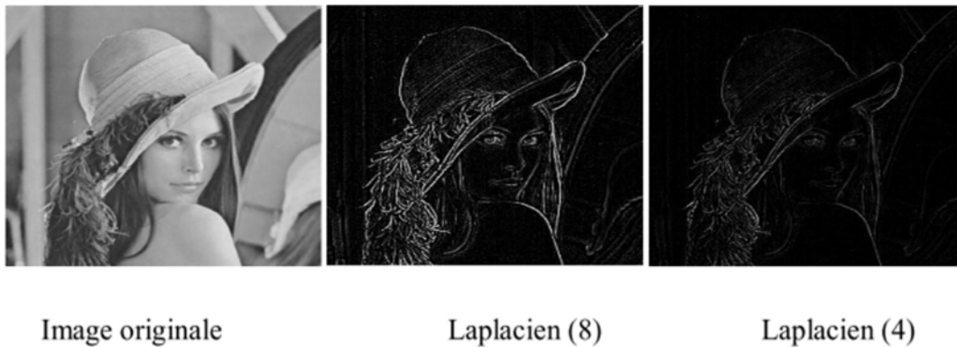
Figure.37: Exemple d'application du filtre Laplacien (4,8).
