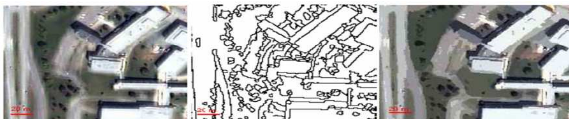
Figure.45: application du principe de la coopération séquentielle contour région
