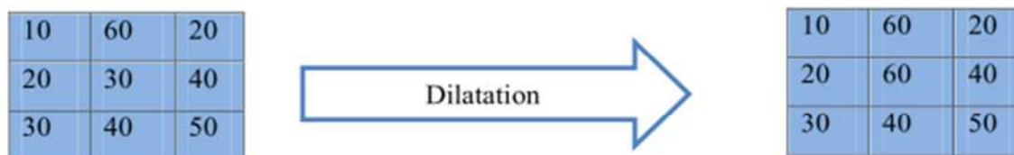
Figure.17 : Principe de dilatation sur l'image en niveau de gris [6]
