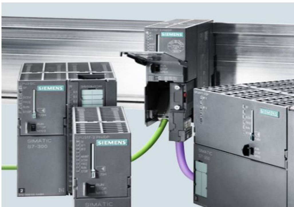
Figure III-2 : L'automate S7-300 de SIEMENS.
