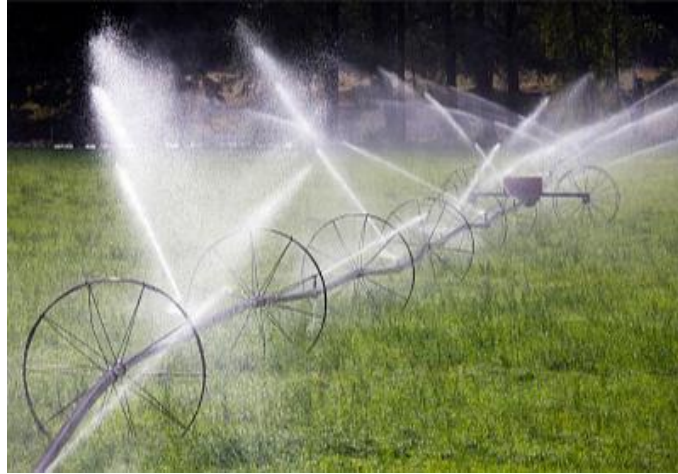
Figure I. 8: irrigation par aspersion mobile sur une roue
