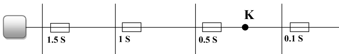
Figure II-4 : Protection avec relais à maximum de courant [8].
