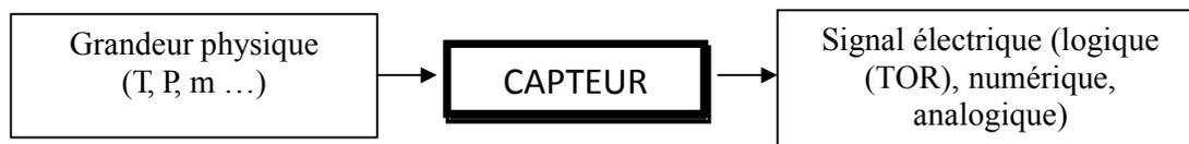
**Figure 4.1** : Principe générale d'un capteur
