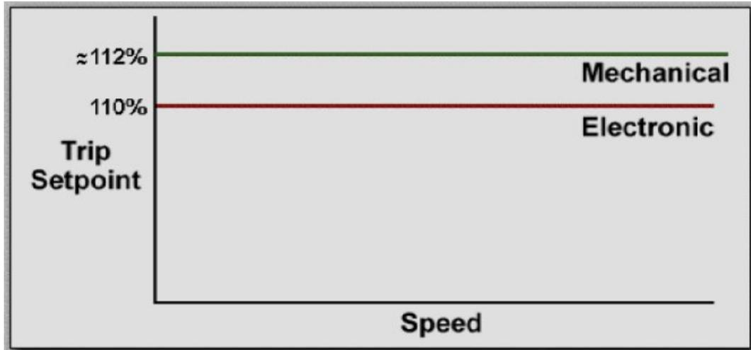
Figure 4.4: Points de déclenchement électronique et mécanique
