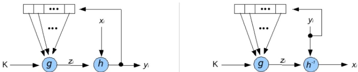
**Figure I.4 Cryptage et décryptage asynchrone**
